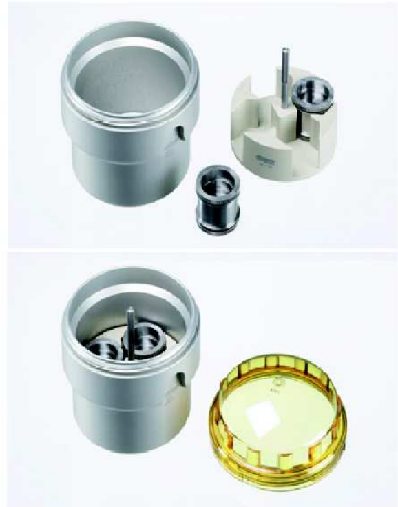
Gehänge 4750 mit Deckel 4751 und dem Spezialzubehör für die Bestimmung des Wasserrückhaltevermögens.
